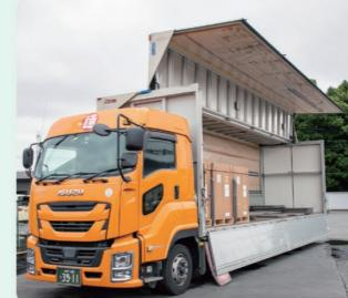
大型のトラックの両サイドが大きく開閉するので、一度にたくさん荷物の積み降ろしができ、フォークリフトを使った作業もできるので効率的です。
