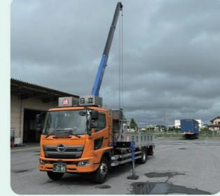
トラックの荷台部分に、クレーン装置を搭載した車両です。建築資材の積み降ろしや、機械を運ぶ時などによく使われる特別なトラックです。
