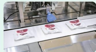
包装は機械を使って、一つひとつパッケージングし、コンベアを流れています。
