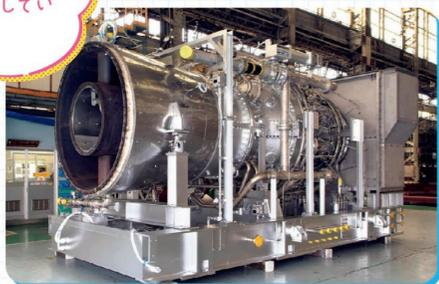
全長30m超の製品もあり、1分間に最高3,600回転の超高速で電力を供給します。安心安全に運転できるのは、日立工場の技術で0.01mm単位の精密な製造が可能だからです。
